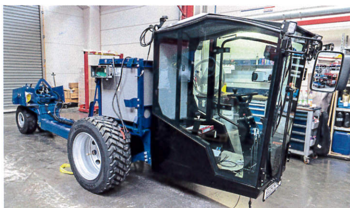
Ein eTruck während der Montage: Die 1 200 kg schwere Batterie lastet direkt auf die Antriebsachse. Die Kabine ist speziell für den eTruck konzipiert worden.
