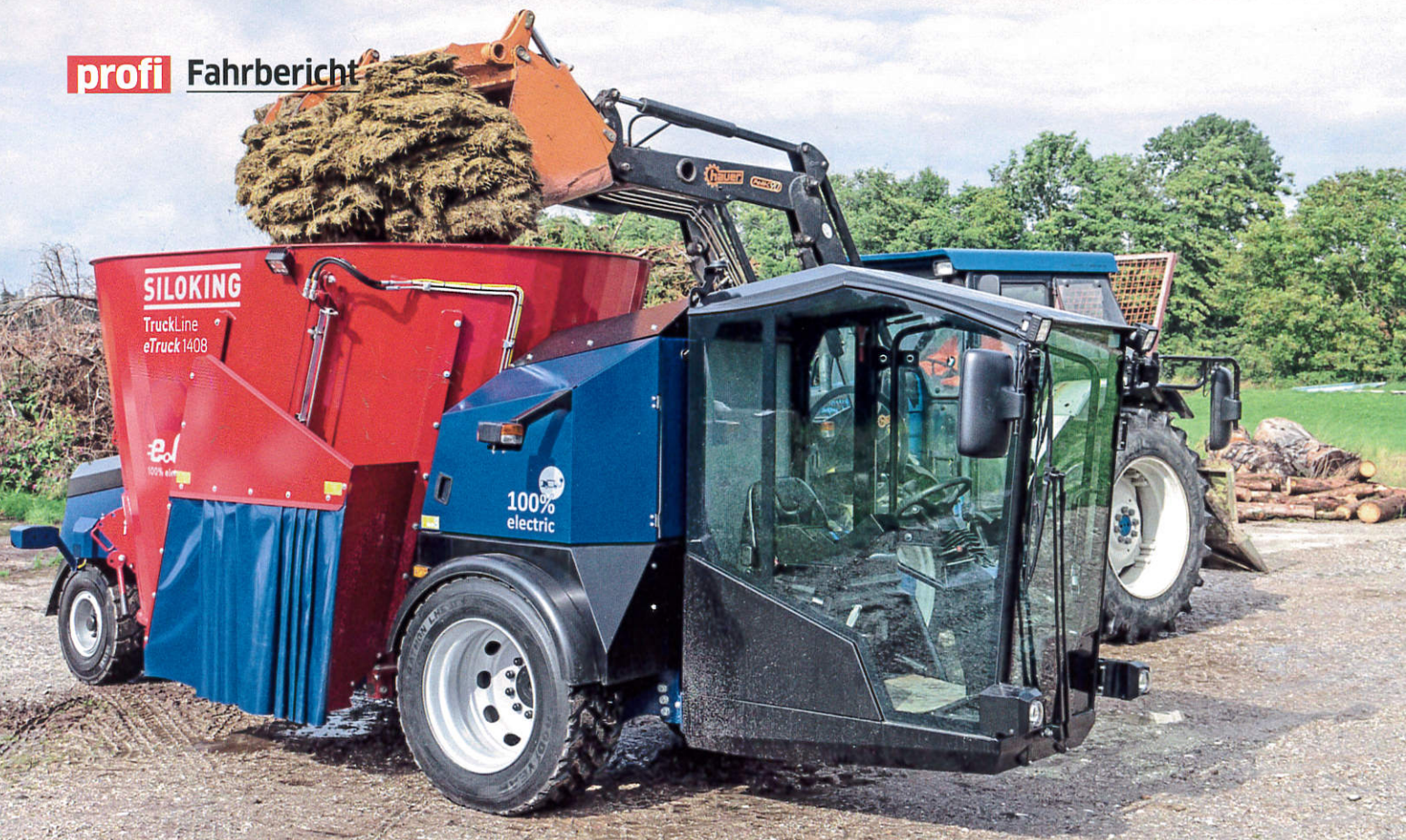
Der eTruck von Siloking arbeitet mit einem elektrischen Antrieb und ist sehr kompakt gebaut. Fotos: Bensing
