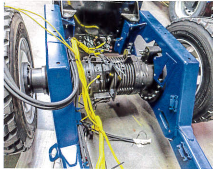
Die Antriebsachse stammt von einem Stapler von Jungheinrich. Sie hat 18 kW Leistung.
