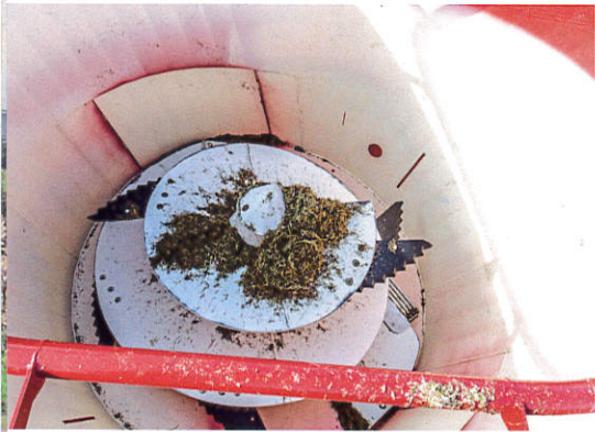
Die Schnecke wird von einem 15-kW-Motor direkt angetrieben. Siloking programmiert drei Drehzahlen in die Steuerung. Mit bis zu 45 U/min wird der Behälter fast restlos leer.
