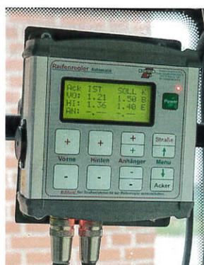
Die Reifendruckregelanlage von Strotmann funktioniert sehr gut, hält aber über Nacht nicht dicht, wenn die Kugelhähne offen bleiben.
