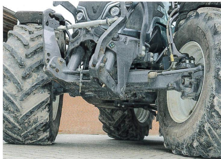
Statt der jetzt aktuellen Luftfederung ist dieser N noch hydraulisch gefedert. Der Fahrkomfort und die Wendigkeit gehen aber kaum besser.
