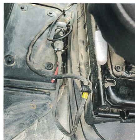
Für die Steckverbindung unten am Sitz wurde eine Halterung nachgerüstet.
