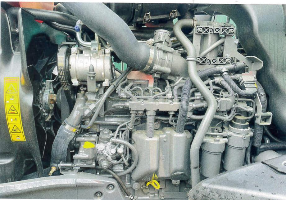
Unter der Haube schlägt bei beiden Testkandidaten der 7,4 l große AGCO-Power.
